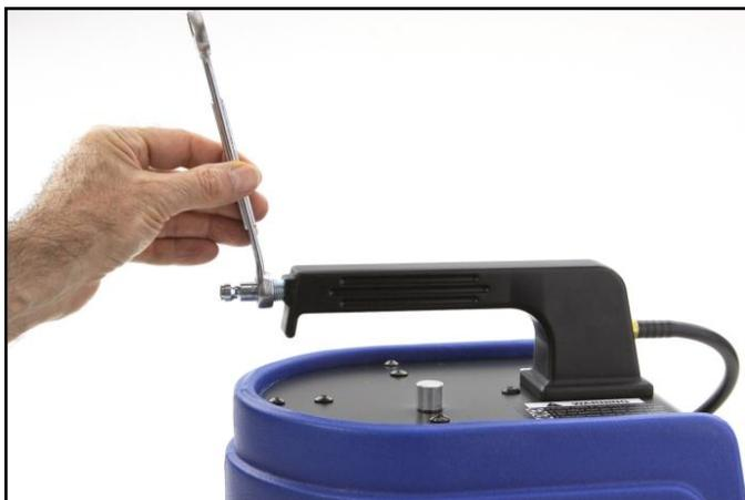
> Si elle n'est pas fournie ; installez un raccord d'air adéquat sur le Leakfinder®.
