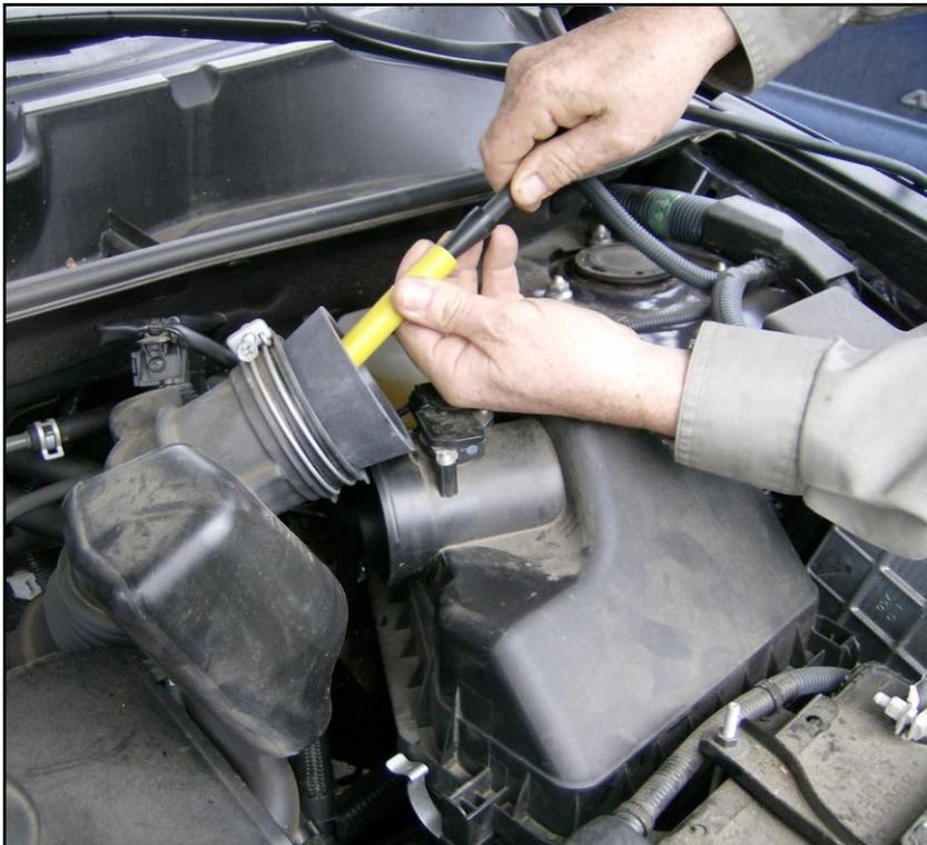
> Utilisez le cône pour accéder au système d'admission et connectez le flexible d'alimentation de fumée au cône.
