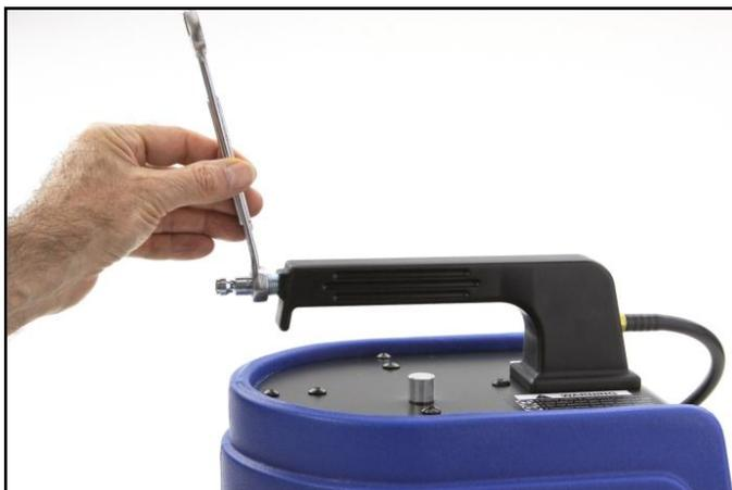
> S'il n'est pas fourni ; installez un raccord d'air adéquat sur le Leakfinder®.
