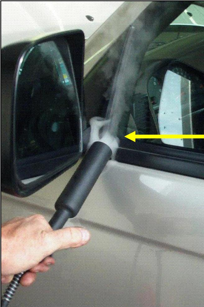
**< Des turbulences dans la fumée signalent une fuite**
